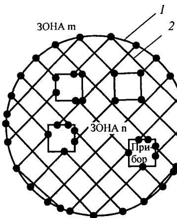
Рис. 4.5. Сетчатое выполнение системы уравнивания потенциалов:
