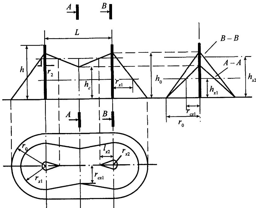
Рис. 3.3. Зона защиты двойного стержневого молниеприемника
